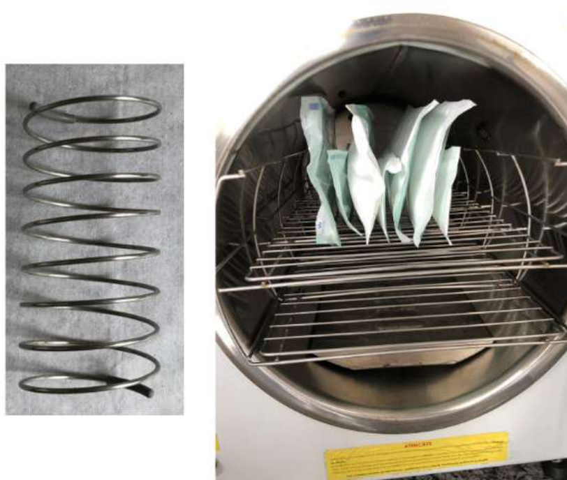
Figura 10: utilização do suporte em espiral para acondicionamento dos envelopes na autoclave
