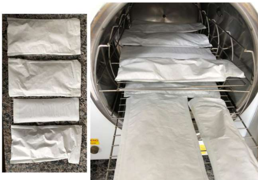
Figura 9: acondicionamento dos pacotes no interior da autoclave
